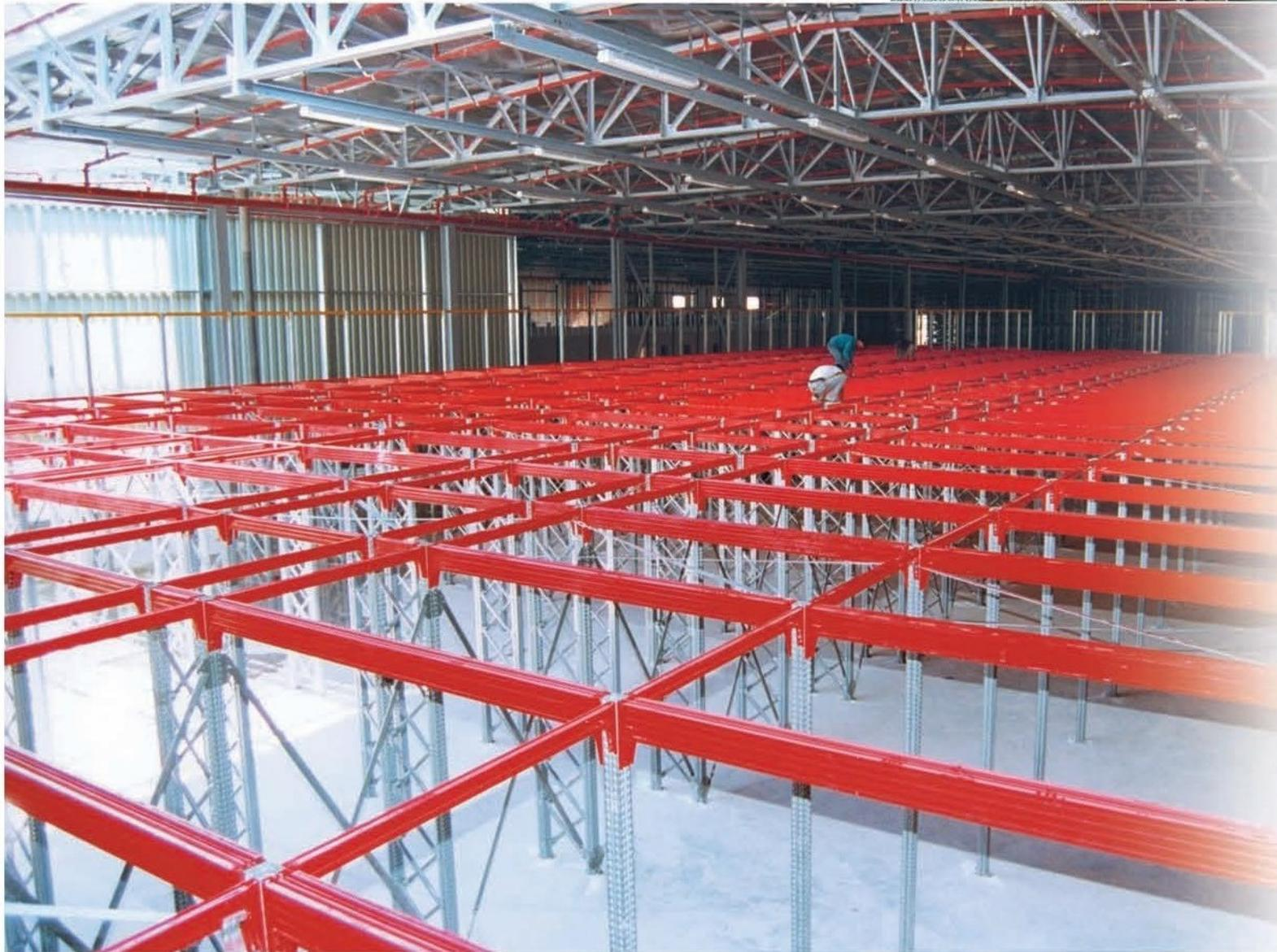
■ Le Super 6 piliers ont huit emplacements au même niveau, permettant la connexion de poutres dans quatre directions à partir de ses quatre faces.
